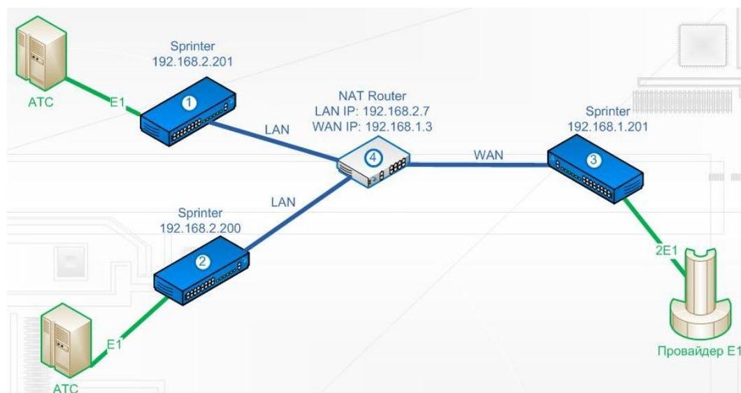
Мультиплексоры-коммутаторы Sprinter TX необходимо настроить следующим образом (функция доступна с версии ПО - LPOS 1.0.9.4SR4):
