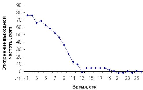
Процесс подстройки и синхронизации выходного потока E1 при первом включении устройства.
